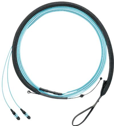
**Stämme** – vorkonfektionierte PanMPO™-Stammkabel ermöglichen rasche Invertierung und Polaritätsänderungen vor Ort für eine standardkompatible Kabelwerkmigration von 10G Ethernet auf 40G/100G Ethernet. Verfügbar in Multimodus oder Einzelmodule, 12-Faser-, 24-Faser- und 48-Fasersystemen.
